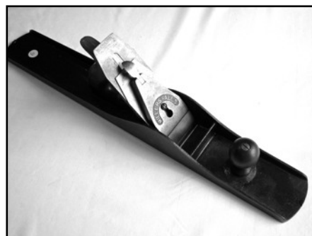
19. Stalen rejschaaf Millers Falls nr.24. Grepen van Cocobolohout. Originele beitel.
