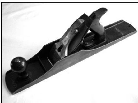
8. Stanley 606. Latere Bedrock met afgeplatte zijken.
