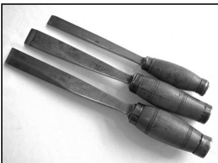
32. Vermoorbeitels met palmhouten handvatten. Twee van Kramer uit Rotterdam en één Ferdinand Rubens.
