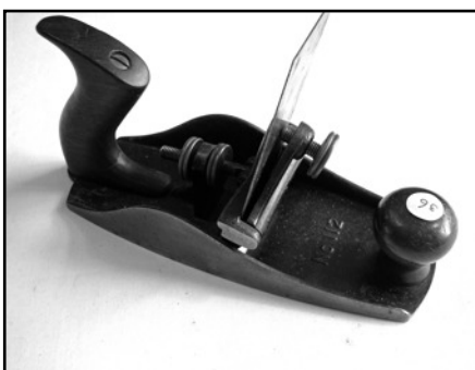
36. Stanley 112. Schraapschaaf met gerepareerde achtergreep. IJzer niet origineel.
