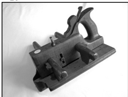
1. Engelse ploeg met achtergreep. In prima staat. Merk: Malloch uit Perth.
