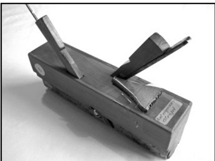
5. Tweemaster messing/groef. Prachtige schaaf in Cormier hout. Met eigenaars slagstempel: Frugier.
