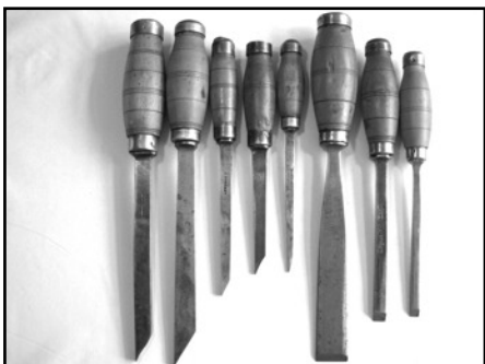
12. 4 schietbeitels en 4 vermoorbeitels. Handvatten van palmhout en steenbeuken van verschillende makers.
