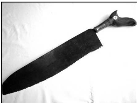
16. 18e eeuwse Hollandse handzaag. Palmhouten handvat met ingesneden versiering en originele messing manchet.
