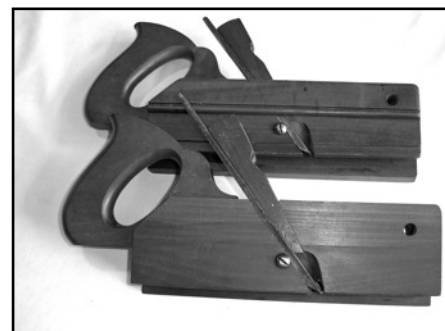
28. Stel messing en groefschaven van Cornier hout. Gemaakt: aux mines de Suede Paris
