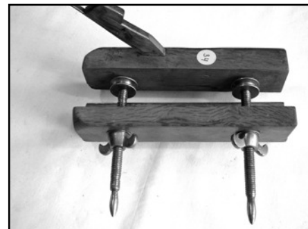
34. Franse veerploeg, steeneiken met stalen schroefarmen en mooie messing vleugelmoeren en stelschroeven.
