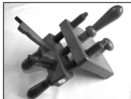
11. Bijzonder mooie Duitse kuipers krooschaaf met drie schroefarmen en met messing ingelegde onderkant.
